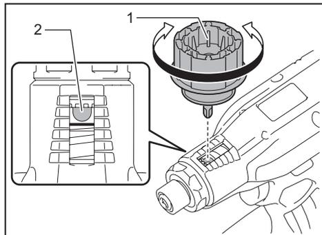
► 1. Chave de ajuste 2. Furo para a chave de ajuste
